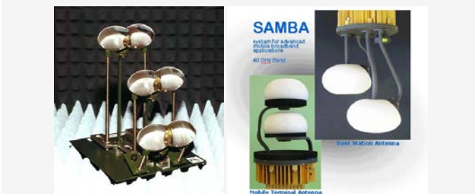
Fig 1 – Antenas dielétricas para sistema de comunicações móveis de banda larga em ondas milimétricas a) Projeto MBS, 62-66 GHz; b) Projeto SAMBA 42.5-46.5 GHz
