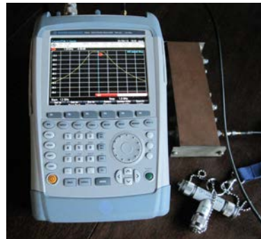
R & S ZVH4 - Resposta de filtro passa-banda em 1.2 GHz
