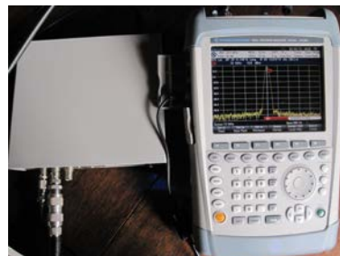
Medida com gerador de referência de frequência de 10 MHz, disciplinado por GPS
