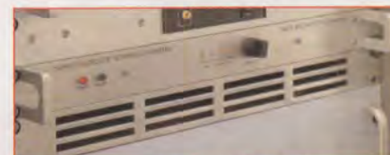
RECEPTOR/DESMODULADOR ESPECÍFICO PARA AS EXPERIÊNCIAS DE TRANSMISSÃO A 38,4 KBPS.
