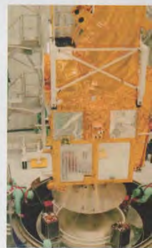
No disco ASAP do Ariane foram lançados, além do PoSAT-1, outros satélites da mesma categoria. Esta espécie de "roupa" amarela (à direita) funciona como isolamento térmico do SPOT-3, o "passageiro" principal do Ariane 4 Voo 59.
