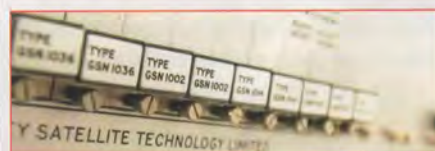
O MÓDULO CENTRAL (ESPÉCIE DE CONTROLADOR DE MATRIZ) É A INTERFACE ENTRE ESTES VÁRIOS EQUIPAMENTOS E O COMPUTADOR.
