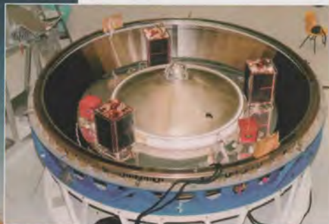
No disco ASAP do Ariane foram lançados, além do PoSAT-1, outros satélites da mesma categoria. Esta espécie de "roupa" amarela (à direita) funciona como isolamento térmico do SPOT-3, o "passageiro" principal do Ariane 4 Voo 59.
