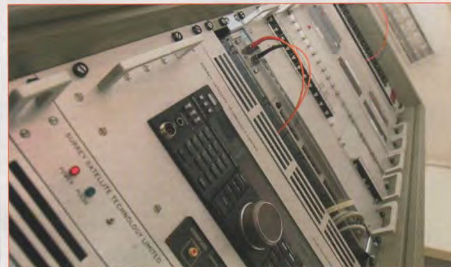
O MÓDULO CENTRAL (ESPÉCIE DE CONTROLADOR DE MATRIZ) É A INTERFACE ENTRE ESTES VÁRIOS EQUIPAMENTOS E O COMPUTADOR.
