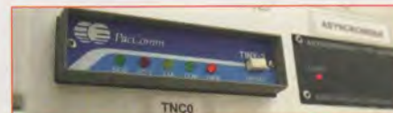
OS TNCs SÃO O SUPORTE FÍSICO DO SOFTWARE DE FORMATAÇÃO E CONTROLO DE PACOTES DE DADOS EXIGIDO PELO PROTOCOLO DE COMUNICAÇÕES AX.25 (QUE RESULTA DE LIGEIRAS ALTERAÇÕES AO X.25).
